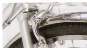
アルミダブルピポッドブレーキ 制動力に優れる ダブルピポッド機構
