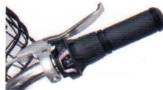
レボシフト(シマノ) グリップから手を離さず 楽々シフトチェンジ
