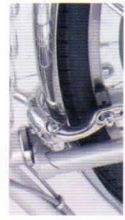
アルミダブルピポッドブレーキ 制動力に優れる ダブルピポッド機構
